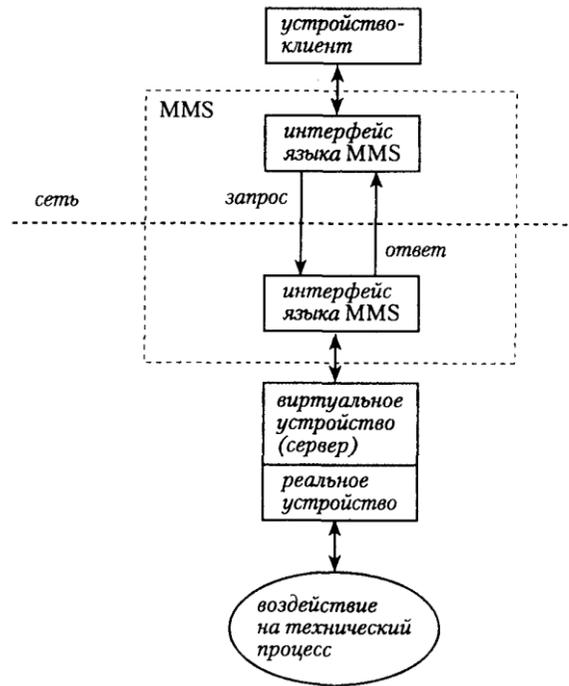
Рисунок 7 - Модель “клиент-сервер” в архитектуре MMS
