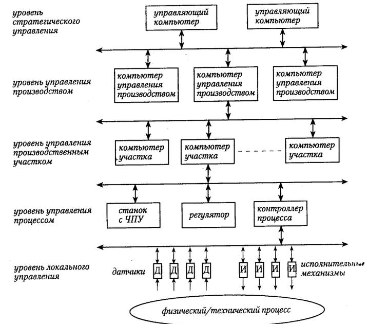
Рисунок 6 - Иерархическая структура распределенной системы управления
